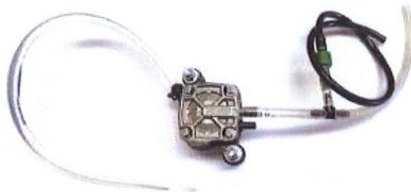
La pompa benzina deve essere fissata sul supporto 651055 o 651056 o 251719 o 651063, attaccato al coperchio frizione (figura destra).
